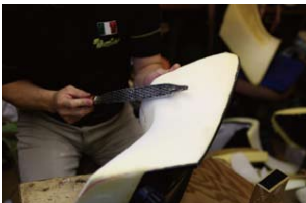
スポンジが荒れるため電動工具は一切使わない。体に染み込んだ経験と勘でやすりを動かし、形を作っていく。ただひとりの乗り手のために、こうして手を使う。
