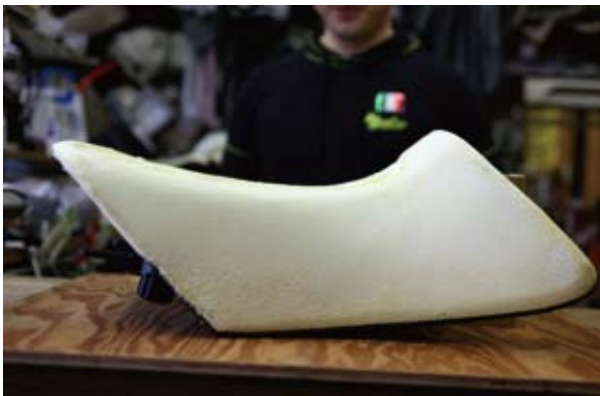
「現行モデルのシートはできがいい。だけど日本人向けに少しセッティングが必要」ということで、RT用ハイシートを加工して作られる『河名のミドル』（4万円）。この後に表皮を張って完成となる。シートヒーター内蔵にも対応可能。座面を水平に近づけ前下がりを解消、さらに脚を出しやすくサイドを削っている。
